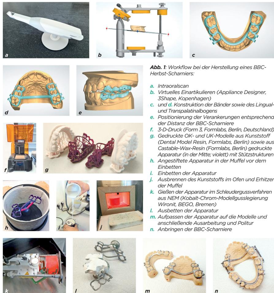
**Abb. 1:** Workflow bei der Herstellung eines BBC-Herbst-Scharniers:
